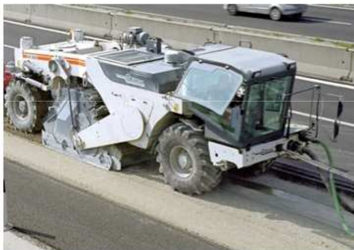
Obr. 1: Recyklér pro recyklaci za studena Wirtgen WR 200i
